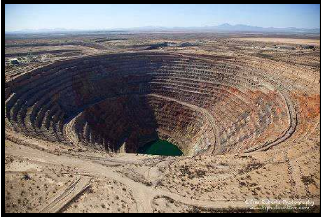
شكل (18-6) المنجم المفتوح ذو المدرجات Open pit bench mine
